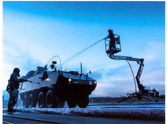
Un véhicule de reconnaissance passe la chaîne de décontamination.
