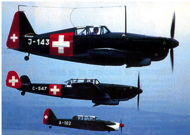
De haut en bas, le D-3801, C-3601 et Pilatus P2 - tous construits pendant la Guerre. Le P2 est un avion d'entraînement, construit à partir de certaines pièces détachées de Messerschmitt 109.
