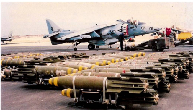
Ci-dessous : Un AV-8B du VMA-231 «Ace of Spades» attend son réarmement. Les bombes sont des Mk.82 freinées, destinées à être larguées à très basse altitude.
