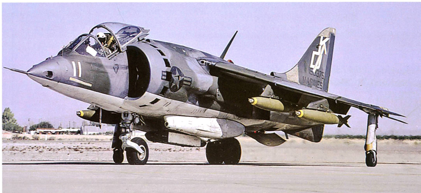
AV-8A de la formation d'entraînement VMAT-203. Il est équipé de quatre bombes Mk. 82 de 227 kg sous les ailes. La première génération de Harrier est également armée de deux canons britanniques Aden de 30 mm installés dans deux nacelles ventrales.
