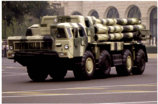
Un des dix-huit lance-roquettes multiples Smerch azéris, photographié lors du même défilé, dont les roquettes de 300 mm peuvent porter jusqu'à 90 kilomètres. Photo © Rorsah via Wikicommons.
