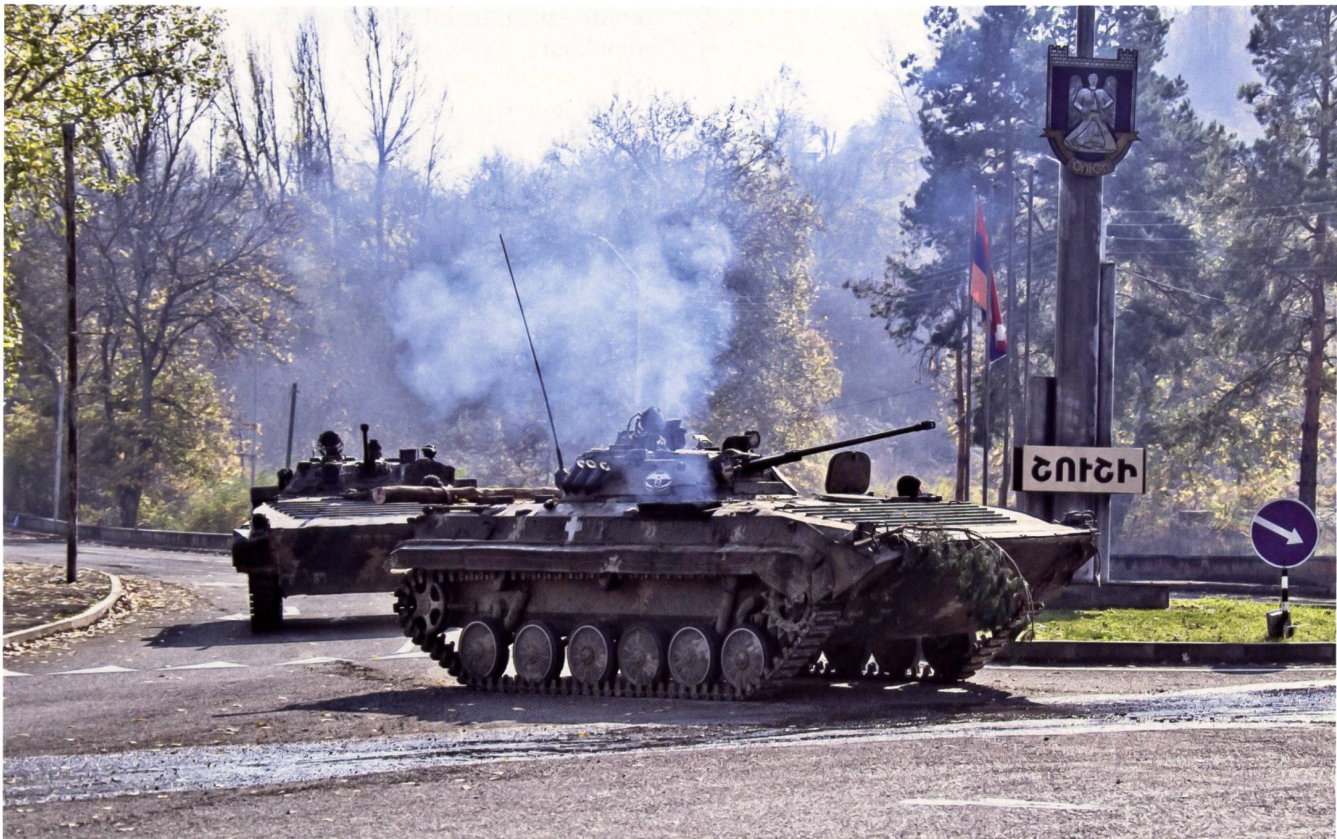
Chars à l'entrée de la ville de Shushi. Chars modèle BMP-2 1960. Armement principal: un canon mitrailleur 2A42 de 30 mm (500 obus) - Un lance-missiles antichar 9M113 Konkurs (4 missiles) - Armement secondaire une mitrailleuse coaxiale PKTM de 7,62 mm (2 000 cartouches).
