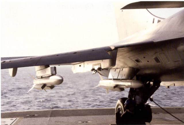
Le missile air-air à moyenne portée Meteor de MDBA est aujourd'hui employé sur l'Eurofighter. Mais en raison de son intérêt à l'exportation, il a été testé sous le Rafale (photo ci-dessous) et les Britanniques sont en train de l'homologuer sur le F-35 (photos du bas).
