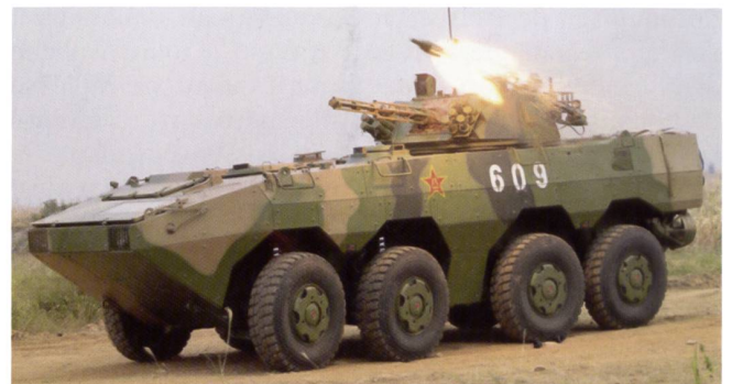
Le ZBL-09 dispose d'une tourelle de 30 mm mais est également capable d'engager des engins guidés antichars.
