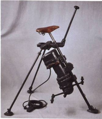
Figure 40: Génératrice à pédales type TG 85 ( Trettgenerator ), construite en 1941 par la firme Scintilla SA à Soleure et destinée à l'alimentation d'un poste radio émetteur-récepteur portable. Les caractéristiques principales sont: puissance env. 80 W, tension pour l'anode 330 V sous 0,15 A; tension de chauffage 8,5 V sous 3,5 A; tension de polarisation de la grille 65 V avec 0,65 mA. On constate, ainsi avec la technique des tubes, que la puissance de chauffage (ici env. 30 W) représente 60% de la puissance nécessaire pour l'anode (ici env. 50 W). La vitesse de rotation des pédales est d'env. 62 min -1 (tours/minute), celle de la génératrice est d'env. 4'650 min -1 soit un rapport de 1 : 75. La génératrice est protégée par un débrayage centrifuge qui agit avec une survitesse de 20%, soit env. 74 tours/min. Cet objet figure également dans la collection de la Fondation MAHAAC à Uster.
