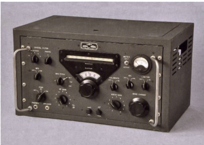
Figure 32: Récepteur à ondes moyennes et courtes COLLINS 51J-4, désignation suisse E-629.
