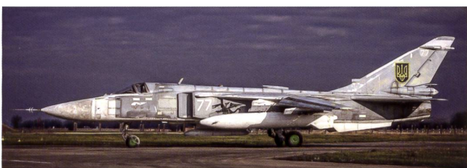
Le camouflage d'origine du Sukhoi 24 trahit son emploi en URSS en tant qu'appareil d'attaque naval mais aussi nucléaire. La peinture blanche, qui recouvre le bas de certains appareils, est sensée atténuer les radiations lors de l'explosion d'armes atomiques.
