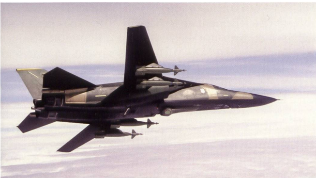
Un F-111F du 493 TFS a sorti sa nacelle de visée et de guidage ventrale Pave Tack et emporte quatre bombes à guidage laser GBU-10 Paveway II de 1'000 kg.
