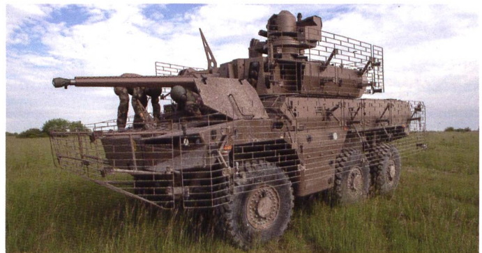
Le Jaguar français est le successeur de plusieurs systèmes à roues. Son armement n'est que de 40 mm afin de combattre la majorité des buts sur le champ de bataille moderne. La capacité antichar prend la forme d'engins guidés pouvant être tirés depuis le côté de la tourelle.
