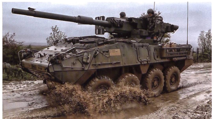
Le M1128 Stryker est une tentative américaine d'employer toutes les technologies disponibles pour réaliser un engin à roues armé d'un canon de 105 mm en-dessous de 19 tonnes.
