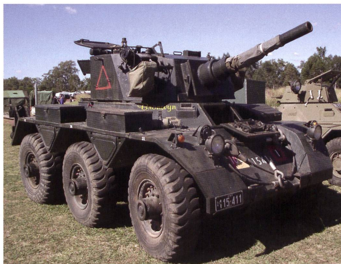
Le châssis à roues 4x4 du Fox ne permettant pas d'adapter la tourelle de 60 mm du Scorpion . Le Saladin 6x6 permet l'emport d'un armement plus important.
