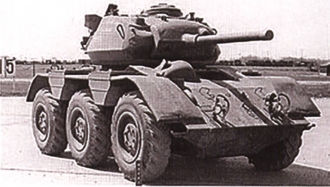
Le succès des M8/M20 a donné lieu au développement par Chevrolet, aux USA, du M38 Wolfhound doté d'une tourelle de char léger M24 Chaffee . Mais la fin de la Guerre a stoppé son développement après la réalisation de quelques prototypes.
