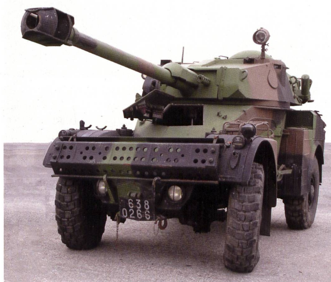
L'AML 90 de Panhard est en mesure d'emporter différents types d'armement, y compris un mortier de 60 mm ou un canon de 90 mm (photo).
