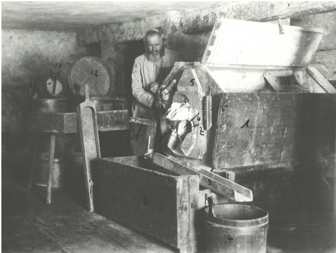
Mulin da graun a Tschier (1922). – 1 chista da farina u chista dal biat – 2 chista da las laidias u da las cristgas– 3 crivel – 4 ster (na sco masira).
