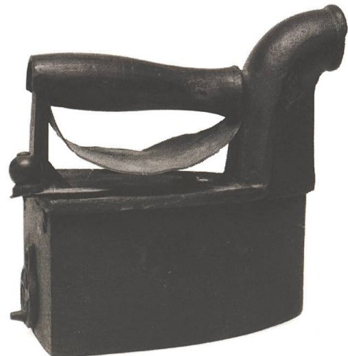
Fier da charvun cun in chamin vi dal viertgel per il fim. Sut il moni da lain èsi in blech per proteger il maun da la chalur (Mustér).
