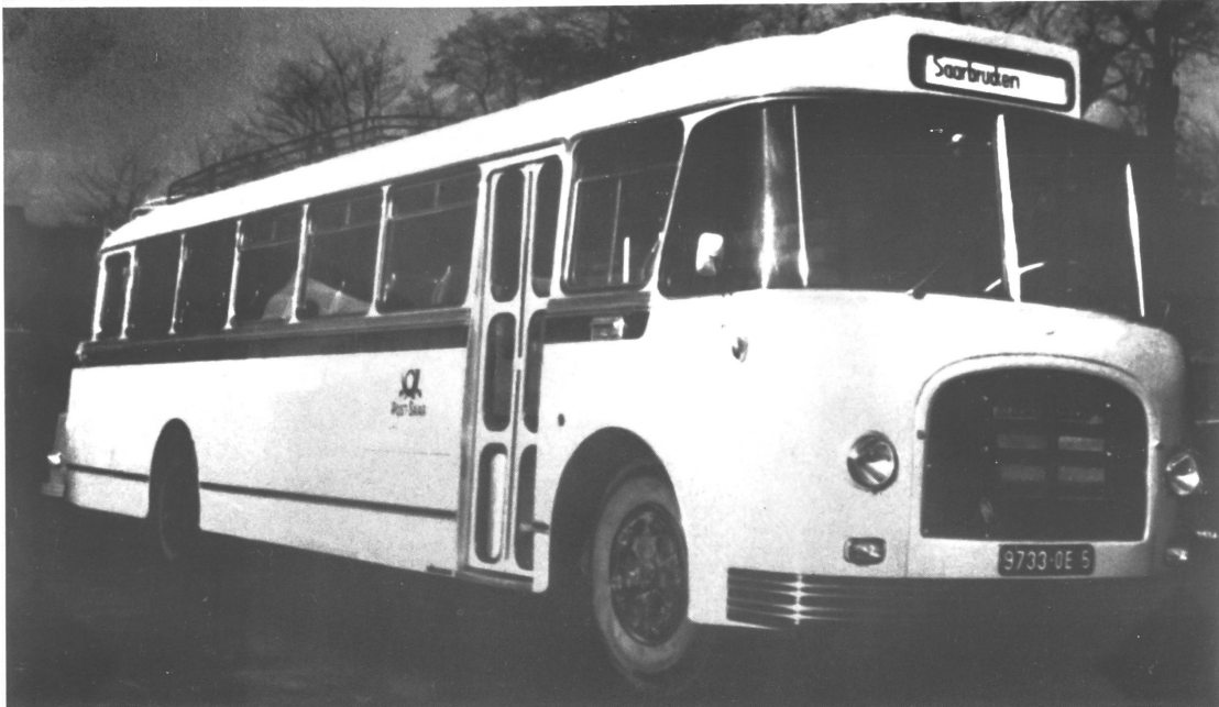
Saurer 4C Motor CT 3 D mit 130 PS. Sonderaufbau für die Post des damals autonomen Saarlandes.
