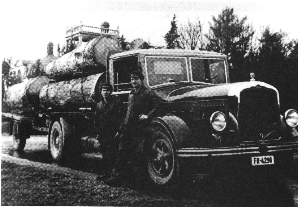
Bild 3: mit Kippbrücke und Einachsanhänger für Holztransporte
