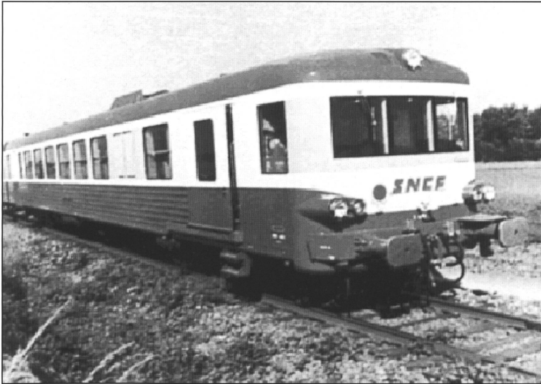
Dieseldieseltriebwagen der SNCF mit 2 x 330 kW
