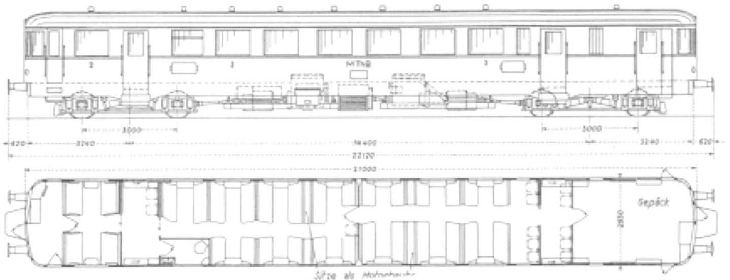
Abb. 1. 300 PS-Diesel-mechanischer Triebwagen der Mittelthurgau-Bahn
