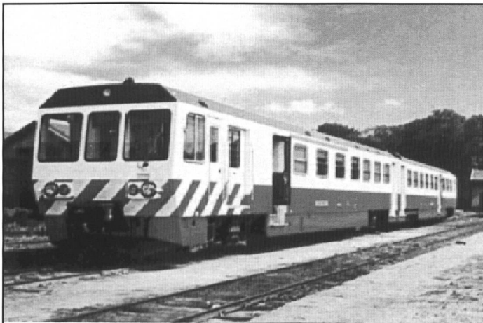
Portugiesischer Dieseldieseltriebwagen mit 1 x 385 kW
