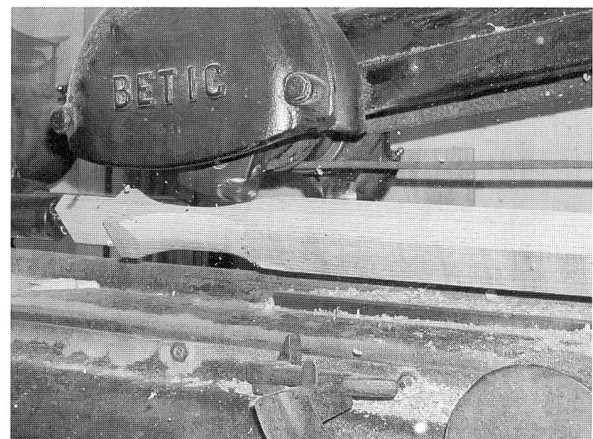
Die Speichenfräsmaschine Modell 1920 im Atelier Monpied am Werk: Es entsteht eine neue ovale Speiche aus Akaazienholz für ein antikes „Automobile“
