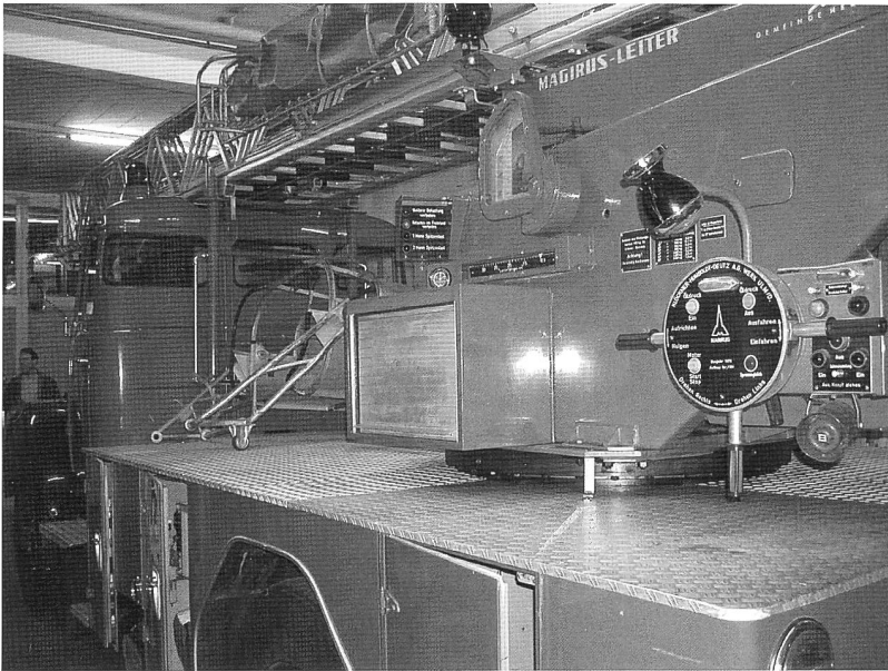
Detail der Magirus-Drehleiter. Das zentrale Bedienelement, die runde Scheibe mit den Hebeln für Heben und Senken, Drehen und Aus- Einziehen sieht eigentlich genau gleich aus wie bei der „Grossmueter“ Tigerberg 51 (Depot Fw Herisau, 18.11.2003)
