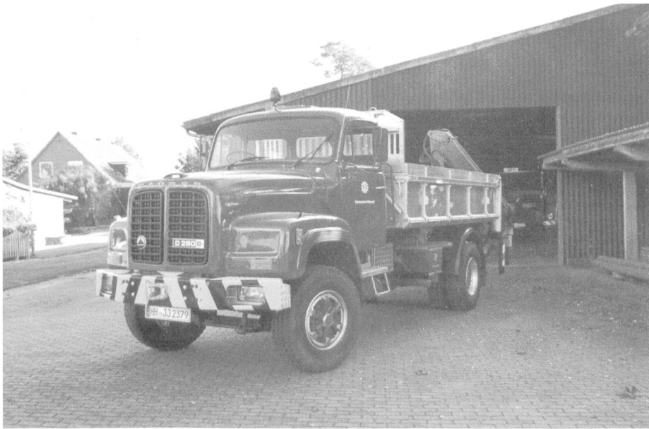
Saurer D 290 BN 4x2 Chassisnr. 211728 Motornr. 113164 Kipper mit Heckkran
