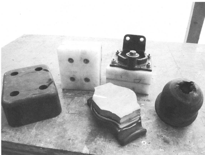
u.r: der Originalanschlag der Achsen, u.l: die Version 1, ein Massiv-Gummiklotz, die sofort wieder platzte dann die neueste Version der Anschläge unten mit Gummi belegt und oben POM Kunststoff
