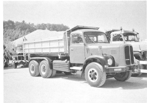
Heisses Eisen: ein seltener 3-Achser, Berna 5V 6x4 mit D1KL-Motor mit mechanischem Saurer-Schraubenradgebläse
