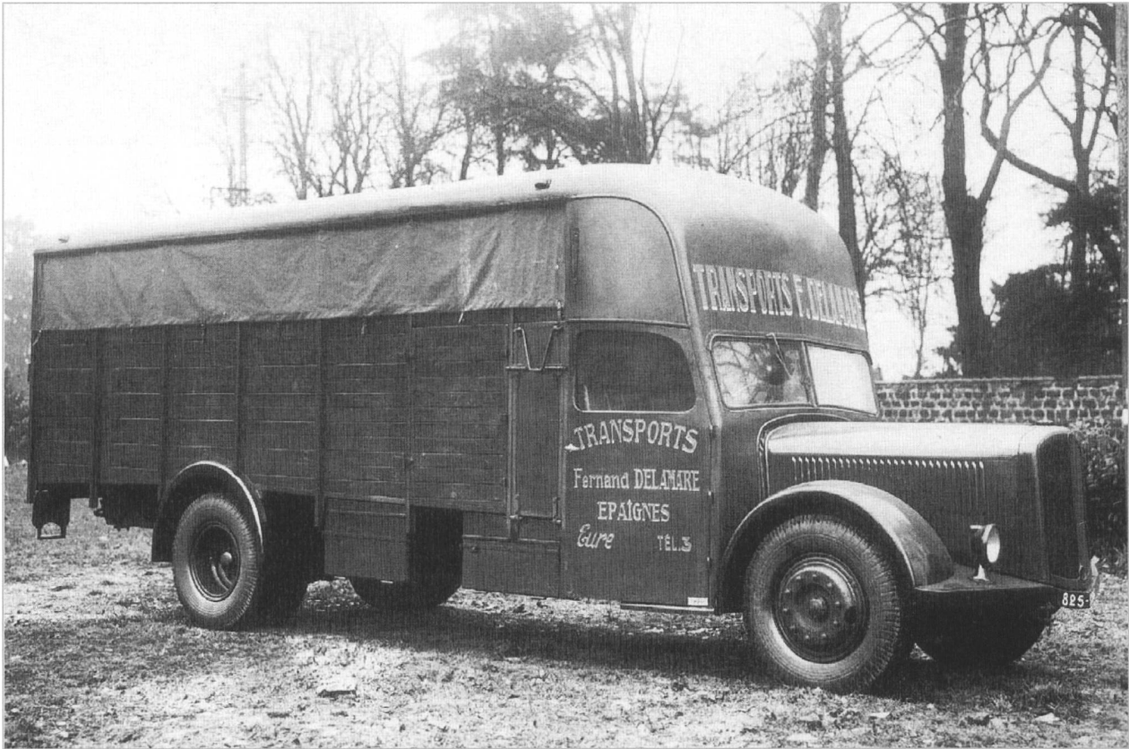
Viehtransportaufbau mit seitlicher Belüftung von Surirey auf 3CT1D. Die Öffnung hinter dem Fahrerhaus ist für das Reserve- rad bestimmt
