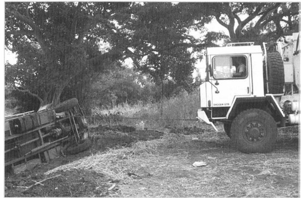
Aufstellen des umgekippten LKWs
