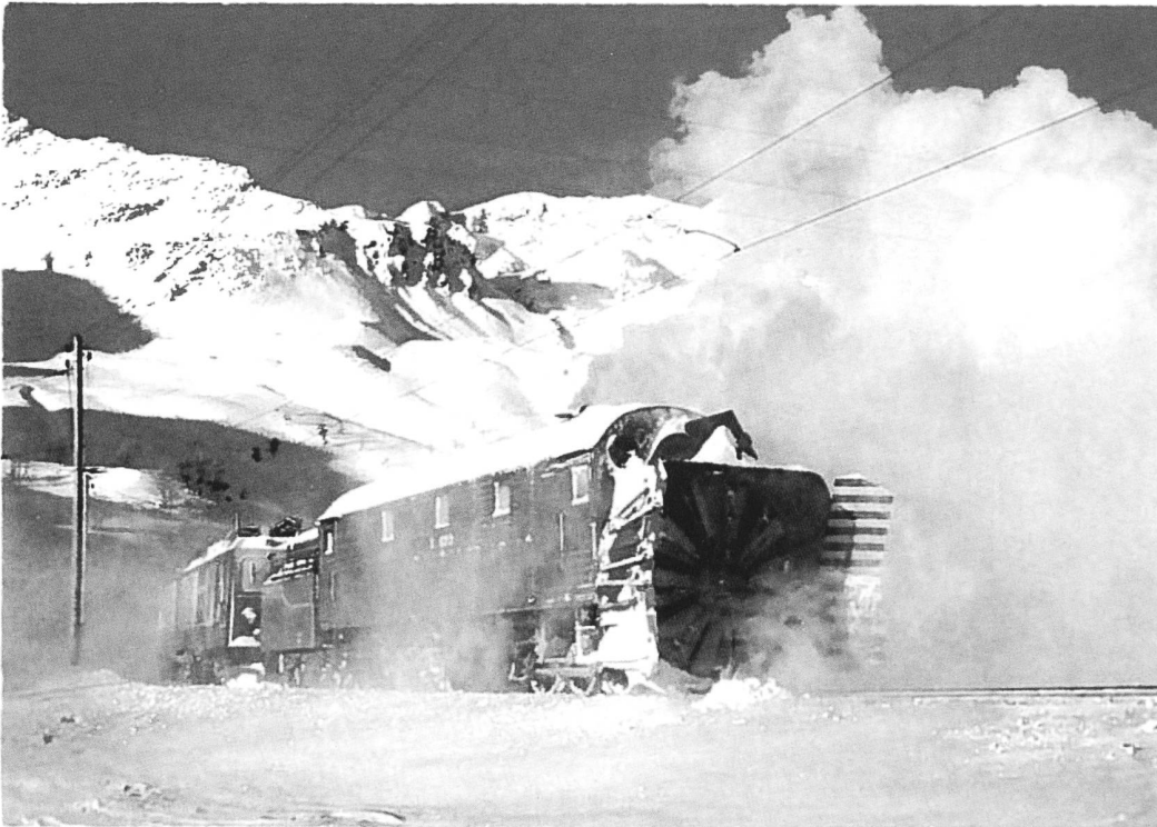
Wohl die mächtigste Schleuder, jedoch auf Schienen: Die Dampfschneesleuder, gestossen von einer Diesel-Elektrischen Lok auf der Bernina-Strecke
