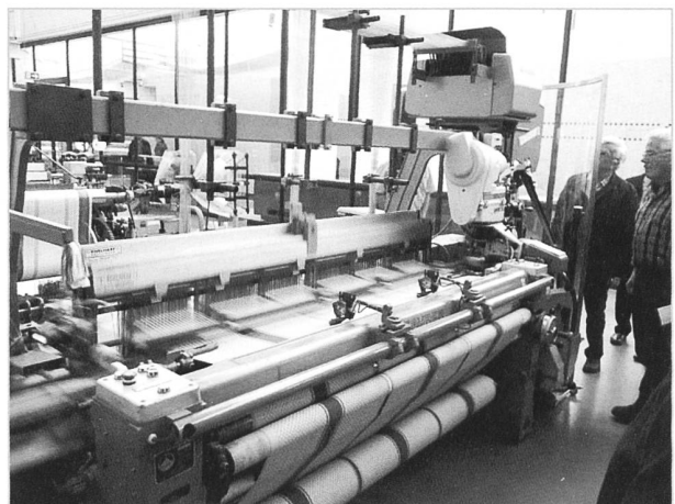
Eine Saurer 300 mit Druckknopfbetätigung. Mit den steigenden Drehzahlen wurde es immer schwieriger, die Maschinen mit dem Handhebel sicher zu starten und zu stoppen. Die Maschine webt immer noch mit einem Webschützen, hat aber eine elektromagnetische Kupplung / Bremse. Anstelle eines Spulenmagazins ist sie ausgerüstet mit einem Unifil-Spulenautomaten. Die Schussspulen werden direkt auf der Webmaschine gespult.
