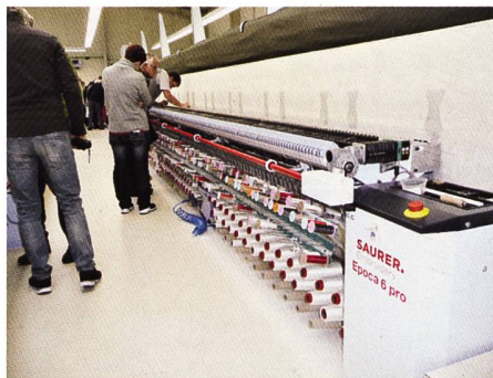
Auf der zweiten Epoca 6 pro wird ein neues Muster eingerichtet
