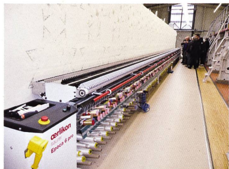
Vorderseite der Epoca 6 pro mit einem Tischdeckenmuster
