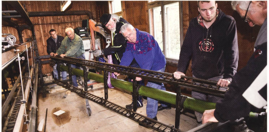
Der vordere der beiden Stickwagen wird abmontiert. Das schwere Teil aus Gusseisen erfordert viele zupackende Hände.
