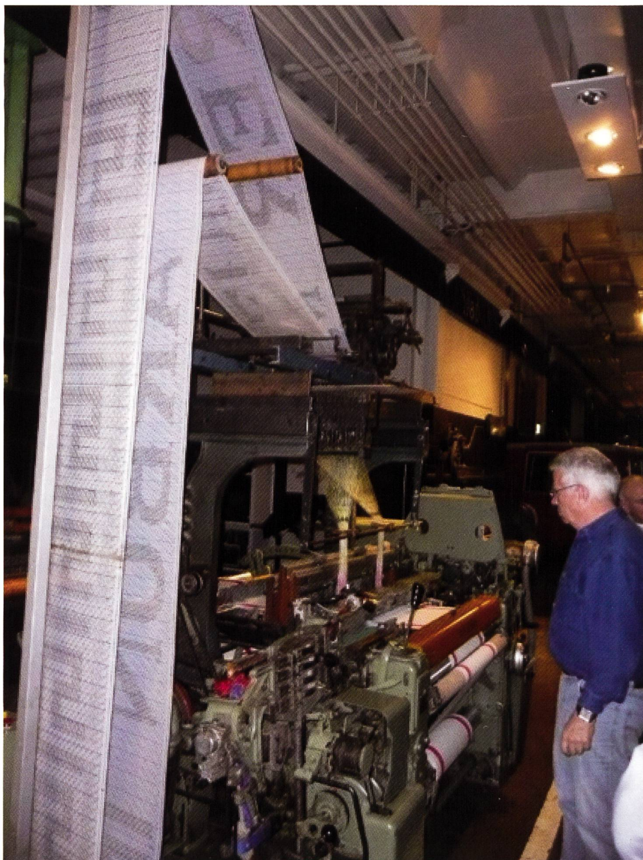
100W Tüchlimaschine Nr. 63'891 von 1978 mit aufgebauter, lochkartengesteuerter Stäubli-Nameneinwebmaschine
