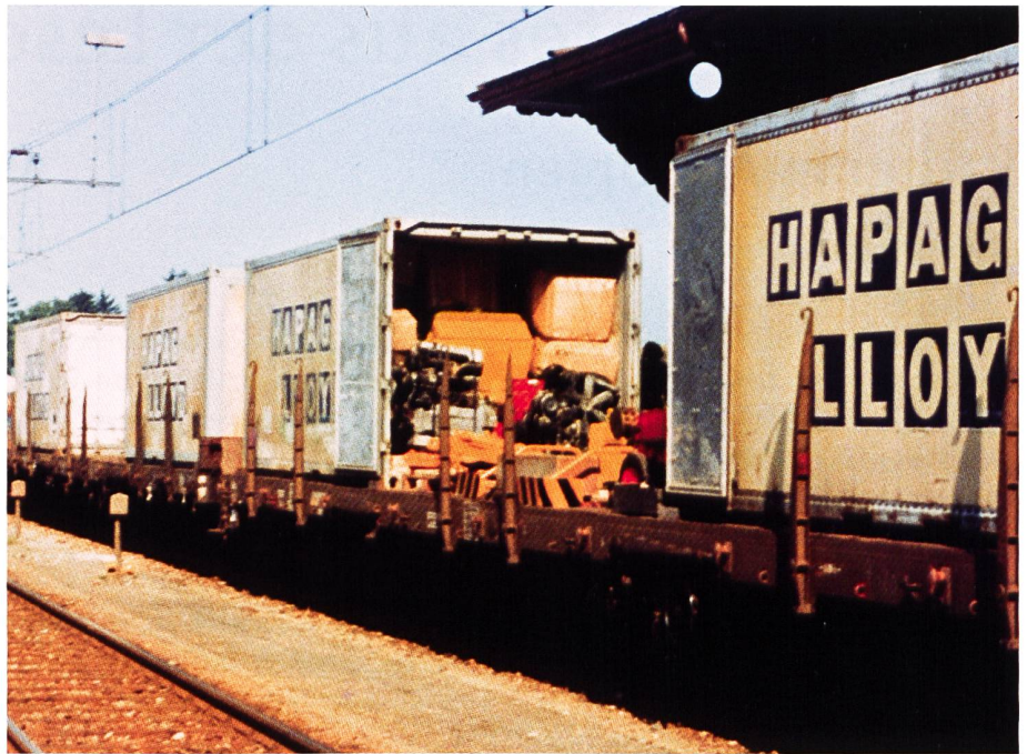
Verlad im Bahnhof Weinfelden: Im Container sieht man 2 Ersatzmotoren hinter dem gelben Heck eines 4MH.
