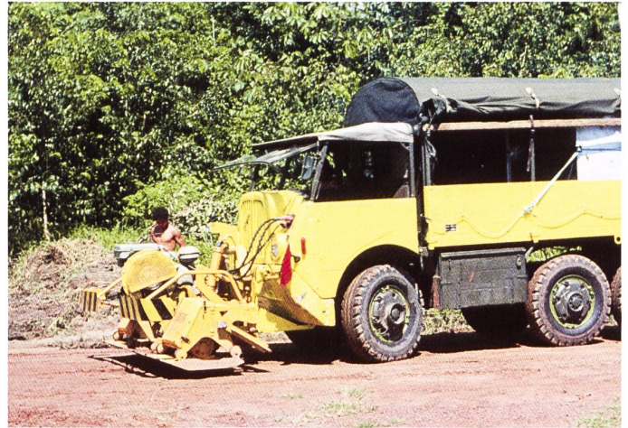
Ein ebenfalls in brasilianischem Gelb lackierter SAURER M6 mit vorgebautem Vibrator im Strassenbaueinsatz.
