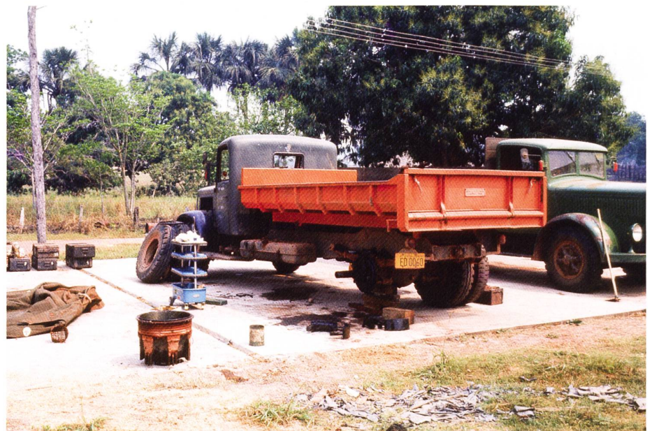
Die Bremsreparatur am SAURER 4C 5t verlangte einiges Improvisationstalent.
