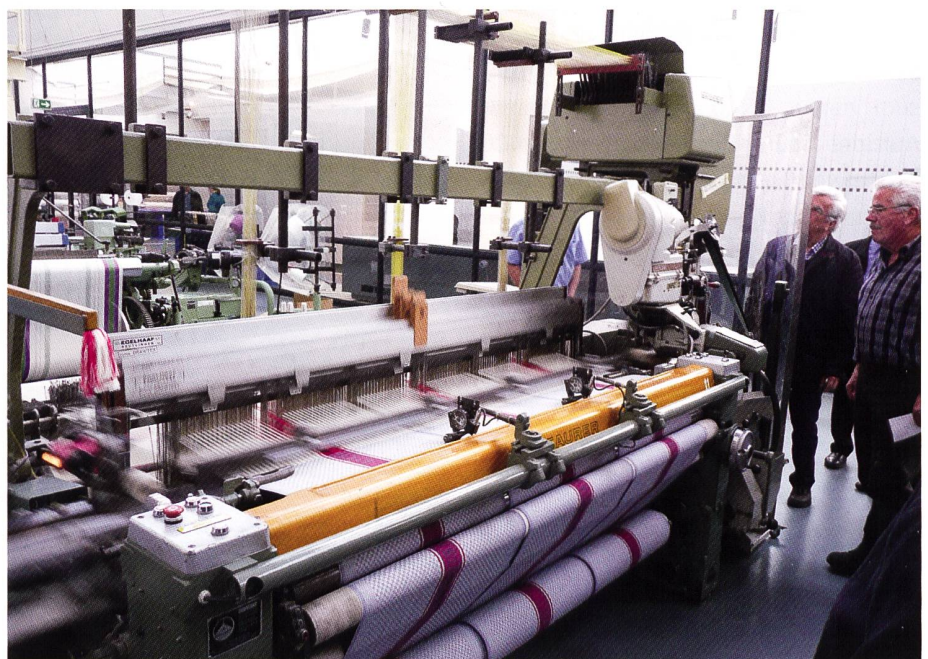
Saurer 300 Webmaschine mit elektrischer Druckknopf-Bedienung, mit Unifil-Spulenautomat, ausgestellt im TIM Augsburg.
