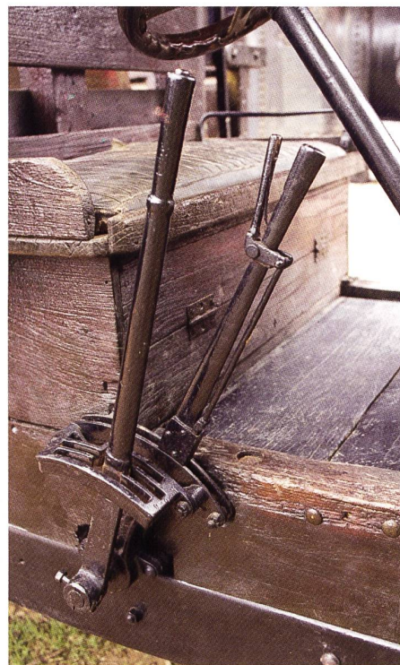
Sowohl Schalthebel als auch Bremse befinden sich ausserhalb der Kabine.
