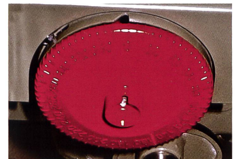
Der Zentralschalter zeigt die Maschinenposition
