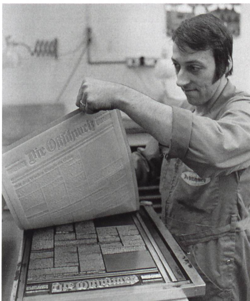
Als Zeitungsmachen in erster Linie noch Handwerk war: Ab einem sogenannten Schiff mit der in Blei gesetzten Titelseite der «Ostschweiz» wird eine Matrize gezogen, die dann als Vorlage zur Herstellung der Druckplatte dient. (Bild: Stadtarchiv St. Gallen)
