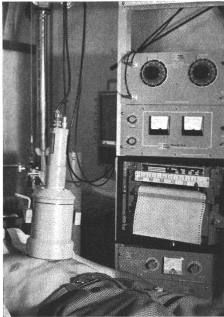
Fig. 1. Dispositif enregistreur pour gammacardiographie. La tête de mesure avec collimateur à grille est placée dans la région précordiale. En arrière l'amplificateur d'impulsions avec discriminateur, «ratemeter» de précision et enregistreur rapide de Honeywell.
