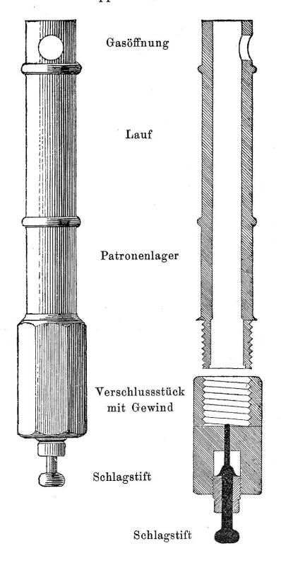
Der Apparat besteht aus dem Lauf, an dessen einem Ende eine seitliche Oeffnung von gleicher Grösse wie das Kaliber, zum Entweichen der Gase angebracht ist. Am andern Ende findet sich das Patronenlager und ein grobes Gewinde zum Anschrauben des Verschlussstückes mit dem Schlagstift.
