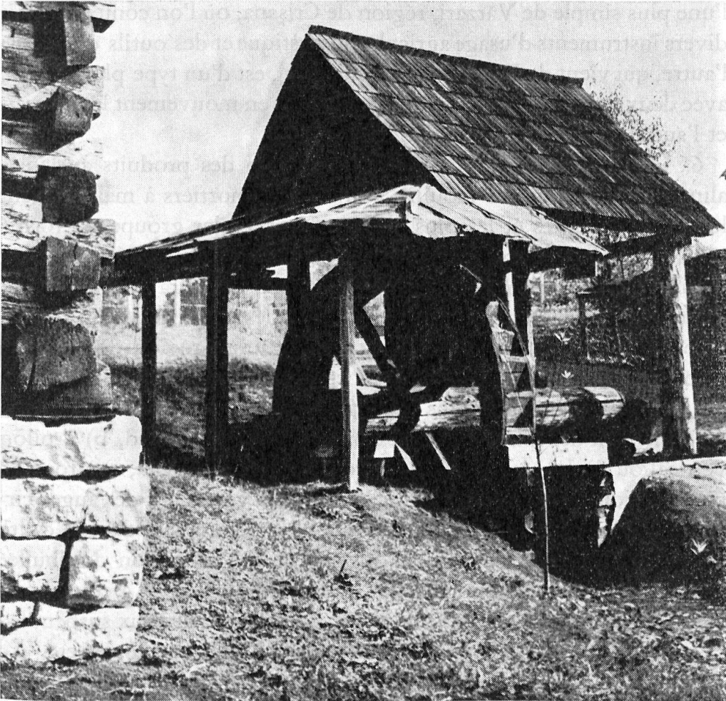
Fig. 5. Installation pour broyer les minerais aurifères des Monts Apuseni.
