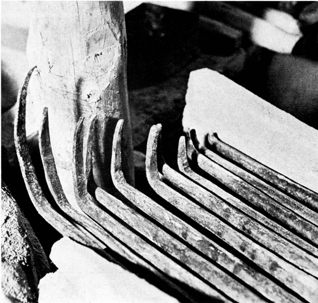
Abb. 9. Eine eindruckliche Kollektion von Hakenstählen. Man beachte, wie die Spitzen sich zu den Schneiden verjüngen. Am deutlichsten ist dies beim grössten festzustellen, an dem sich ein positiver Winkel befindet.
