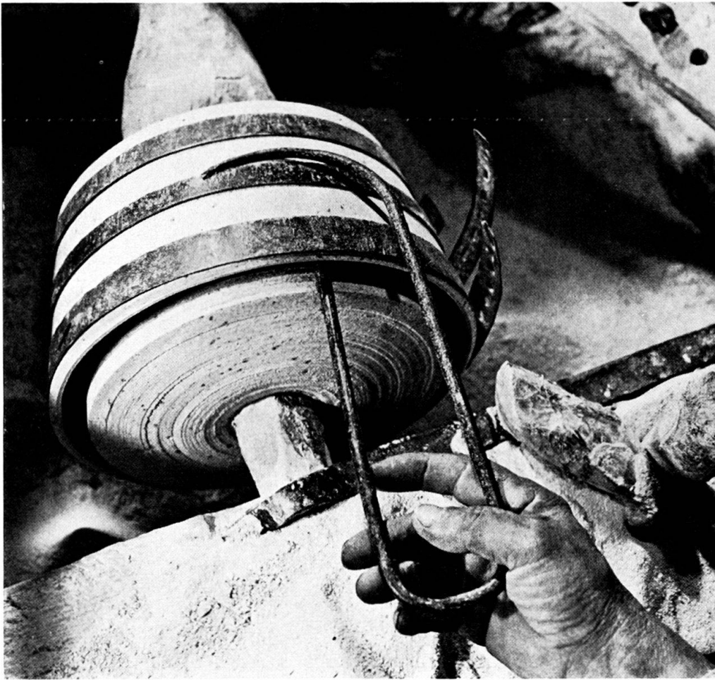
Abb. 11. Das Kontrollinstrument, dessen einer Teil in der Nute steckt, und der andere deren Tiefe auf der Aussenseite angibt. Die entstehende Schüssel ist hier mit drei Reifen bandagiert.
