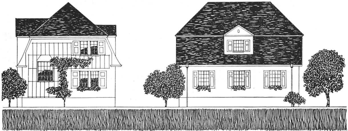
Ueberbauung der Besitzung des Herrn Spychiger in Nidau. — Architekten Moser & Schürch, Biel Fassadenrisse zweier Häuser. Maßstab 1 : 200 (vergl. die Fassaden S. 257 und 260)
