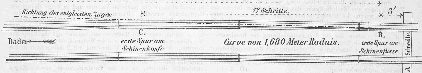
Fig. 3. LAGE DER ENTGLEISTEN FAHRZEUGE.
