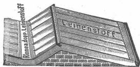
Shed-Dachdeckung mit Rinnenbekleidung
