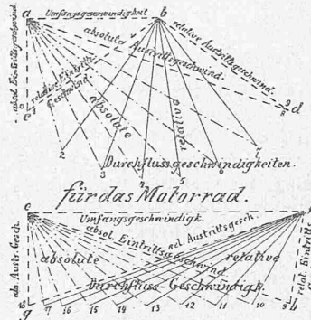
Fig. 8. Geschwindigkeits-Diagramm des äusseren Kranzsystems.
