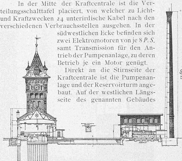
Fig. 37. Kraftzentrale und Dampfkesselhaus. — Verbindungskanal. Masstab 1:800.
