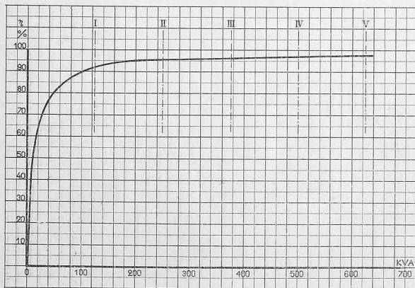
Abb. 80. Wirkungsgradkurve des Transformators, 500 KVA., 11 000/19 000 V.
