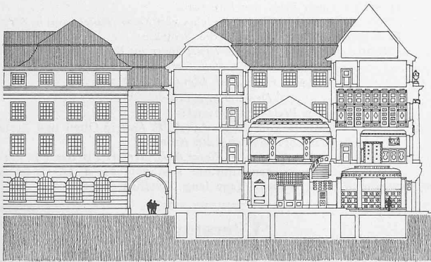
Längsschnitt durch das Gebäude der Schw. Nationalbank. 1 : 600.
