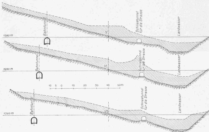
Abb. 5. Querprofile zu Abb. 4. Rutschobel- und Stützbug-Lawine, März 1907. — 1 : 1500..
