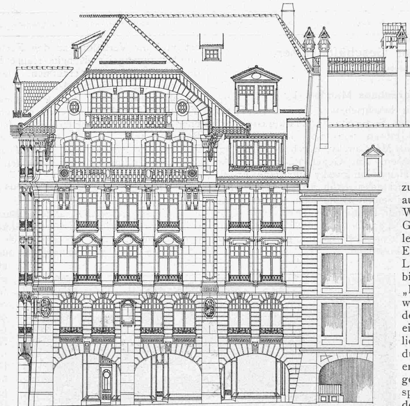
Abb. 12. Fassade des Hauses Zurbrugg gegen den Waisenhausplatz. — 1 : 200.
