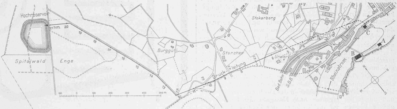
Abb. 1. Lageplan der Zentralen A, B und C mit Druckleitung und Hochreservoir zu C. — Masstab 1 : 12 000.
