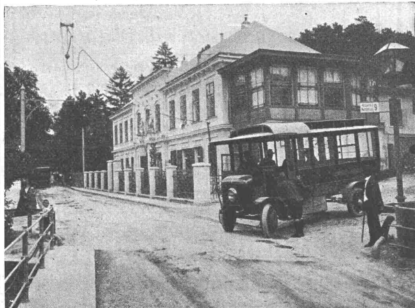
Wagen in Seitenstrasse Weidling, langausgezogenes Kabel. Wagen sind ganz freizügig, passen sich jedem Verkehr an.
