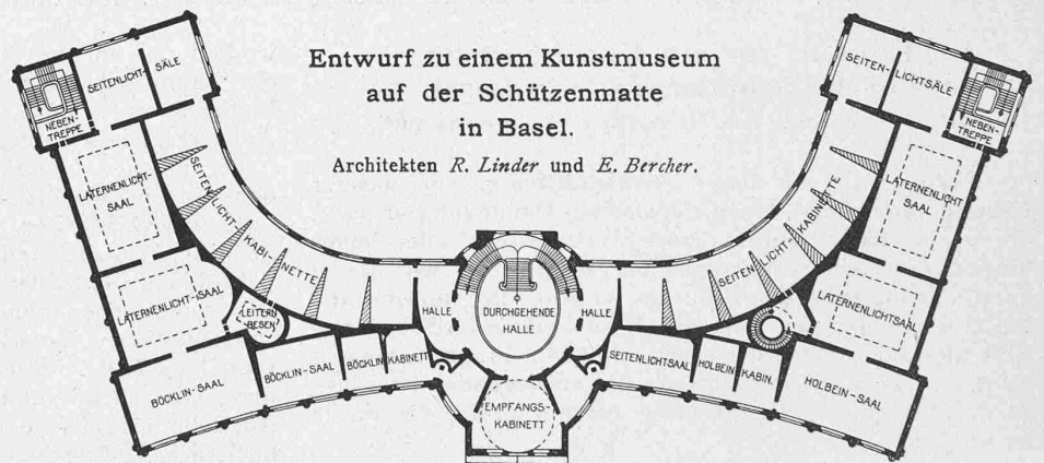
Abb. 5. Grundriss vom Obergeschoss.
